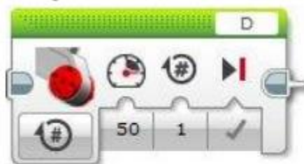
Nagy motor blokk (Large Motor)
